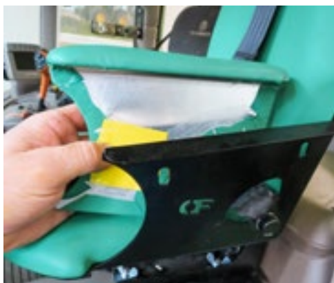
Alle Polster sind geschraubt und können einfach und schnell ausgetauscht werden.
