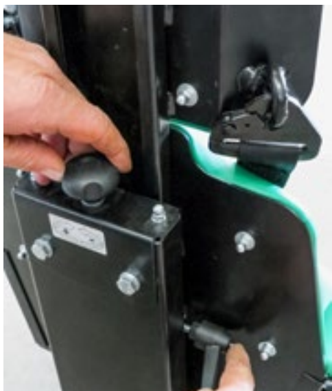
Die Kopfstütze passt sich mittels Feststellhebel der Körpergrösse an. Mit der integrierten Gurtenbefestigung sind diese immer auf der richtigen Höhe. Die Gewichtseinstellung lässt sich über den Drehknopf regeln.
